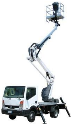
P.L.E. con STABILIZZATORI
